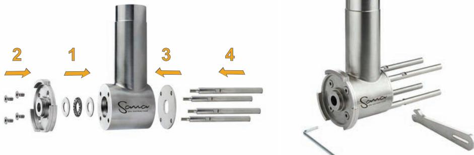
1. Вставьте подшипник и кольца уплотнителя в основную часть насадки в таком порядке, как показано на рисунке сверху.
