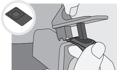
Otevřete zátku výpusti šťávy, držte odšťavňovací komoru i zátku v jedné ruce a druhou rukou vyndejte těsnění. Myjte v teplé jарové vodě.
